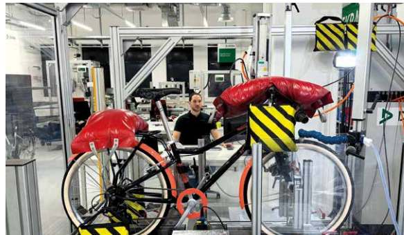
Auf dem Bremsenprüfstand mussten die Räder zeigen, dass ihre Bremsen bei Trockenheit und Nässe gut funktionieren. ©ADAC/Ralph Wagner
